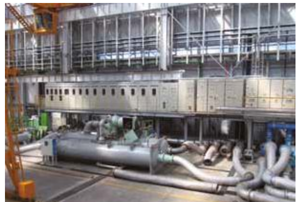
Максимально возможная мощность чиллера для тестирования (3000 RT, 11 кВт)
